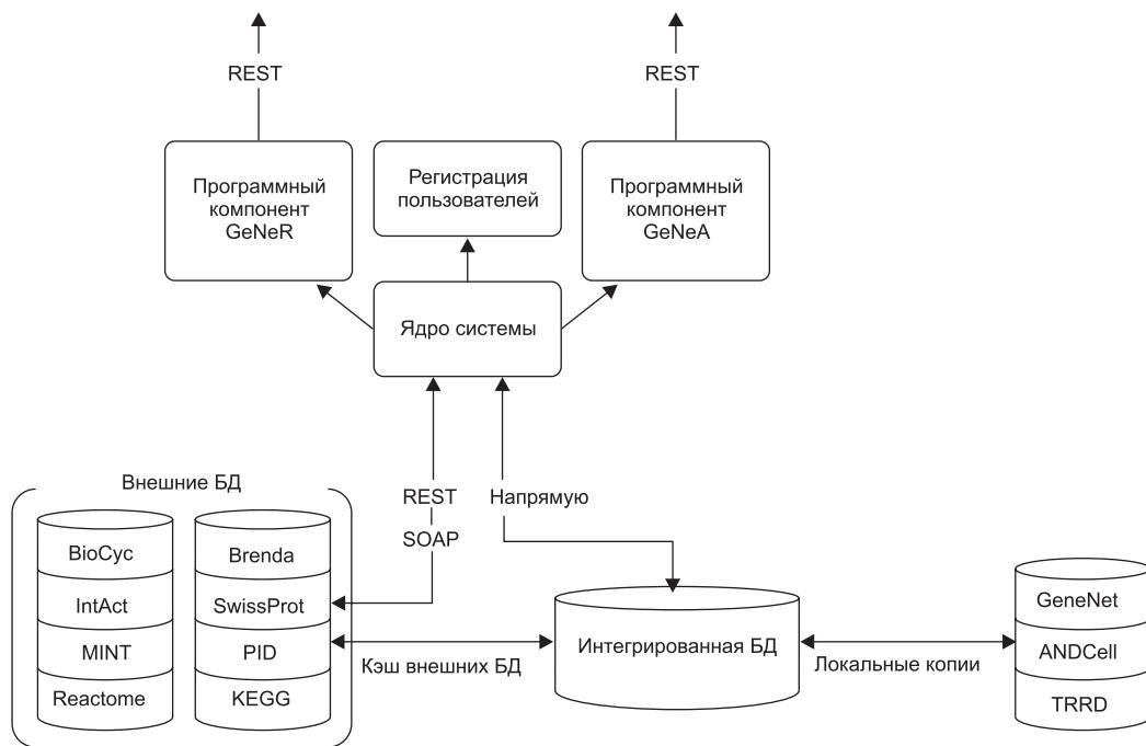
Рис. 1. Архитектура системы реконструкции и анализа генных сетей.
