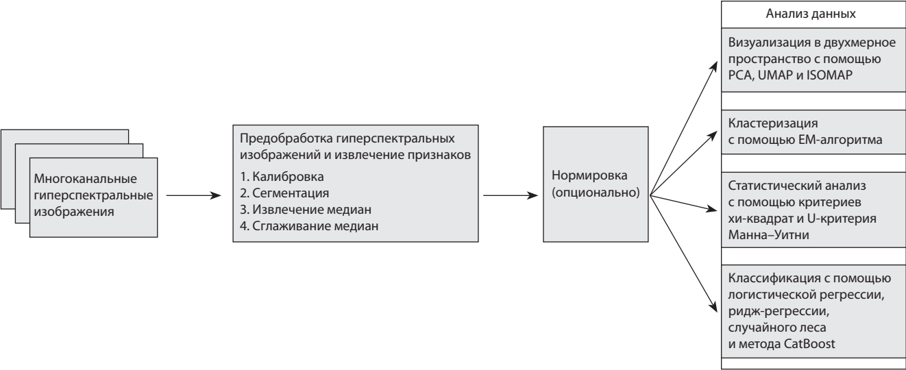
Рис. 2. Схема конвейера для анализа гиперспектральных изображений.
