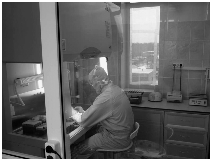
Рис. 1. Процесс проведения эксперимента в одном из чистых боксов межинститутского сектора молекулярной палеогенетики ИЦиГ СО РАН (г. Новосибирск). Работа проводится в чистом боксе под ламинарным шкафом, обеспечивающим сверхчистую рабочую зону. Персонал использует комплекты спецодежды для работы в чистых помещениях.
