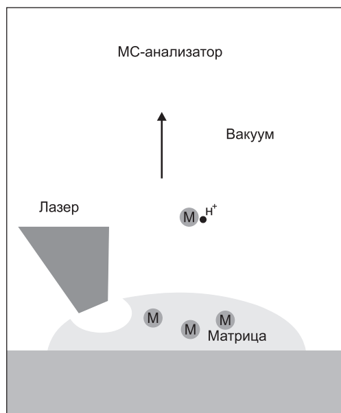
Рис. 1. Схема процесса ионизации в условиях МАЛДИ.
