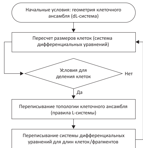
Рис. 2. Блок-схема программы, реализующей симпластный рост ткани.
