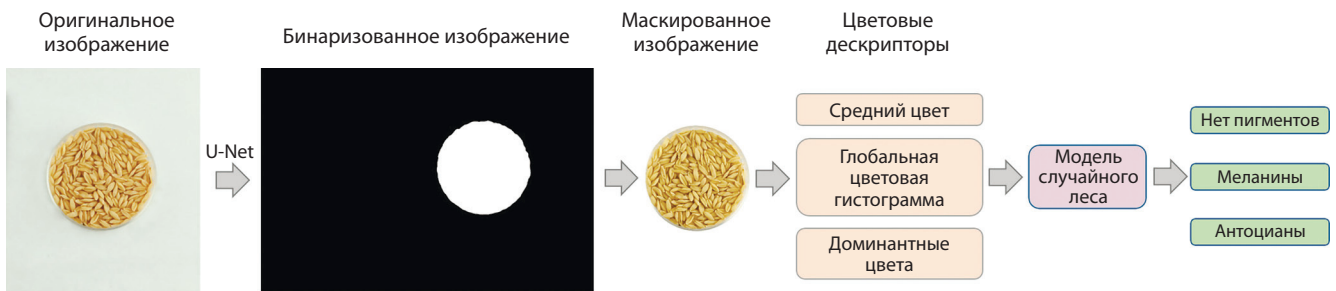
Рис. 3. Схема модели классификации зерен ячменя на основе изображений и алгоритма случайного леса с использованием цветowych дескрипторов.
