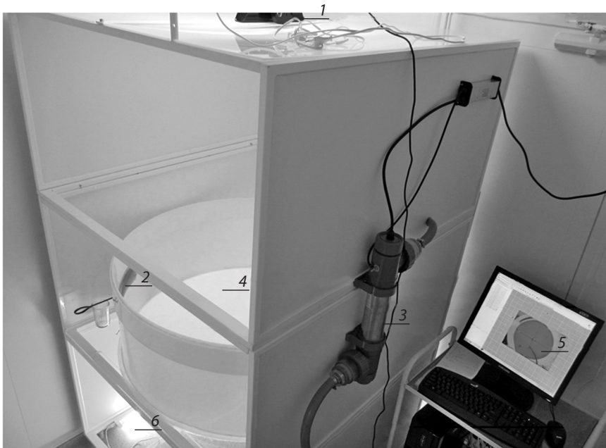
Рис. 1. Общий вид ВЛМ для трассировки животных в проходящем свете. 1 – видеокамера; 2 – ближний ориентир; 3 – ультрафиолетовый очиститель; 4 – бассейн; 5 – компьютер; 6 – лампа.
