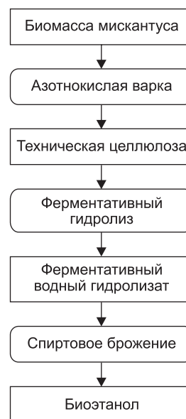
Рис. 1. Принципиальная технологическая схема получения биоэтанола из биомассы мискантуса.
